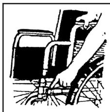
9. Для снятия боковин (для моделей со съёмными боковинами) нажмите на нижний замок и вытащите вверх боковую плату.
