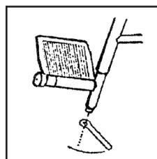
3. Для регулировки высоты подножек используйте болт-фиксатор на подножках.
