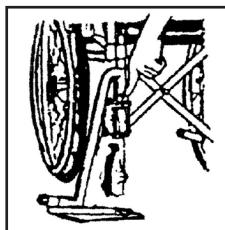
10. Для снятия подножек нажмите на фиксатор для снятия подножек с фиксации.
