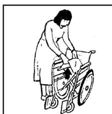
2. Для складывания кресла поднимите опоры подножек, а затем потяните сидение вверх.
